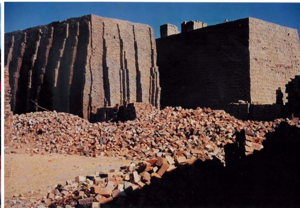
**Le rendement varie assez peu : on obtient en général 80% de briques bien cuites, 15% de briques surcuites ou pas assez cuites et 5% de pertes. Les briques surcuites sont utilisées comme matériau de remplissage dans les murs, les briques mal cuites subissent une nouvelle cuisson,**
