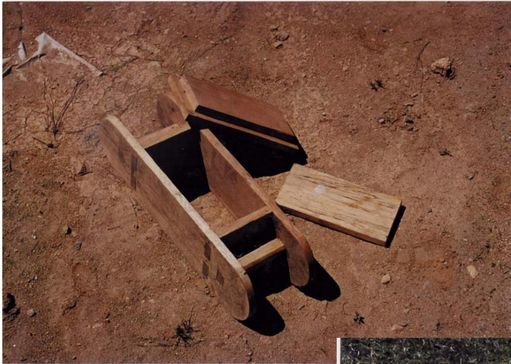
**Le moule pour les briques est installé sur un pieu.**
